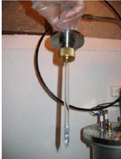
Figura 6 - Dispositivo para pulverizar as amostras [3] .
