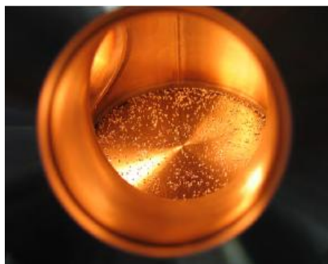
Figura 10 - Amostras no coletor do drop tube queda em microgravidade.
